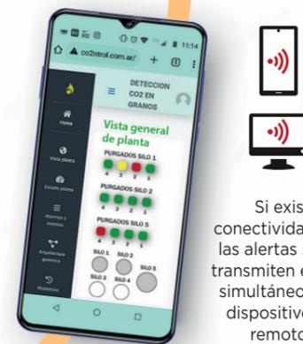
Si existe conectividad, las alertas se transmiten en simultáneo a dispositivos remotos.
